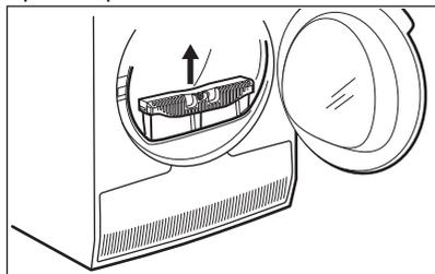
2. Aprire la copertura del condensatore.
