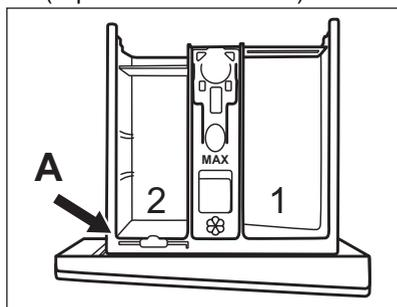
2. Per usare anche detersivo liquido/ additivo o candeggina: Togliere il divisorio del detersivo dalla posizione **A** e inserirlo nella posizione **B**.
