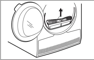
2. Aprire la copertura del condensatore.
