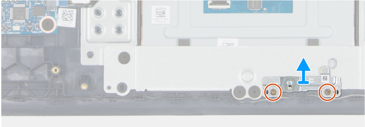
Figura 41. Rimozione della staffa della batteria
