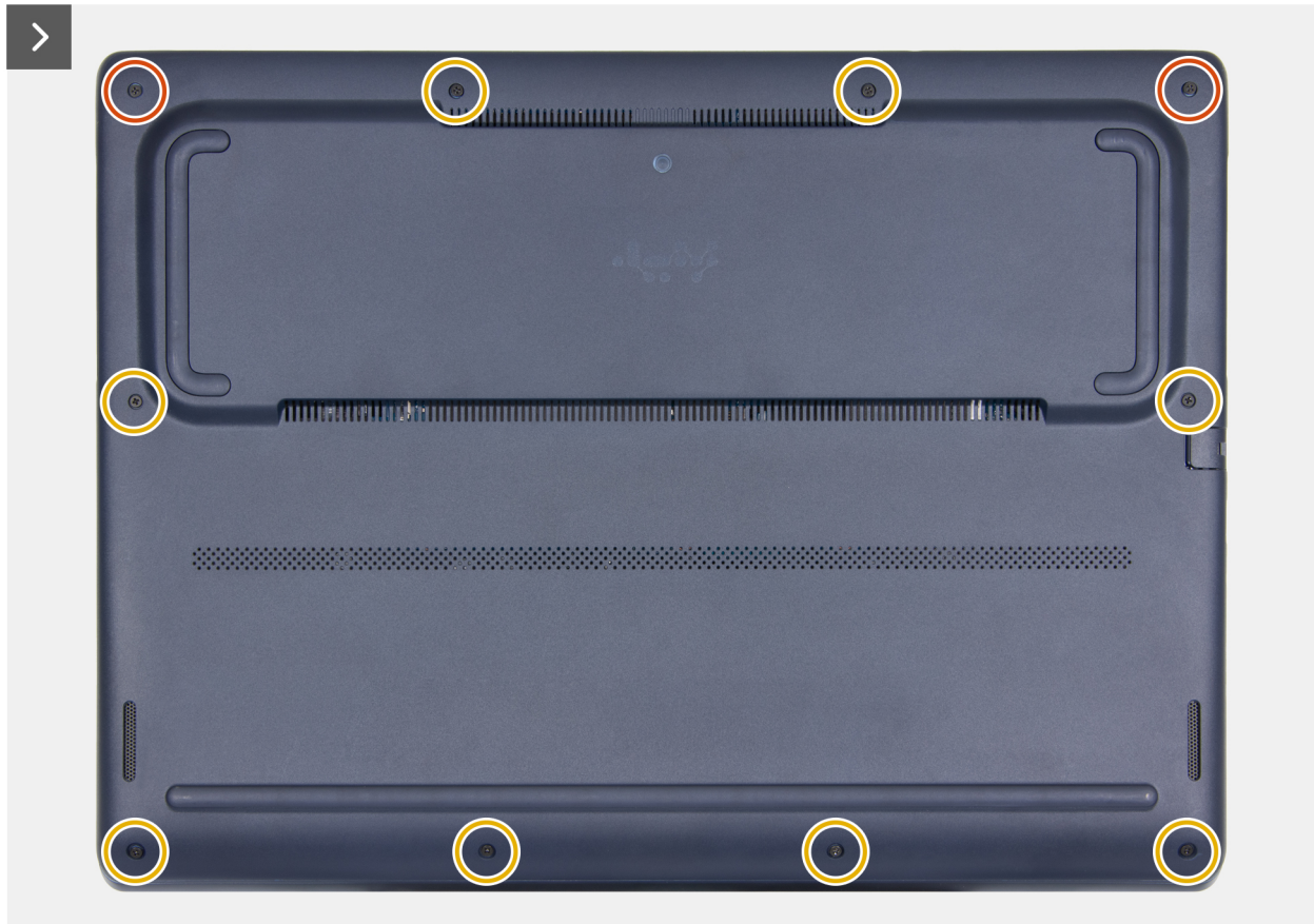
Figura 10. Rimozione del coperchio della base
