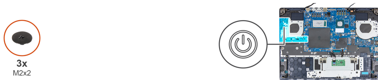
Figura 58. Installazione del pulsante di accensione e della relativa scheda
