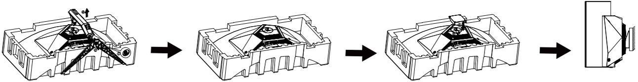
Questo monitor può essere montato su un sostegno a muro che deve essere acquistato separatamente. Scollegare l'alimentazione prima di iniziare questa procedura. Attenersi ai seguenti passaggi:
