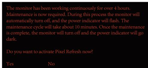
Dopo ogni 4 ore di funzionamento cumulativo, la funzione di correzione della compensazione dello schermo e l'eliminazione dell'immagine residua viene eseguita automaticamente quando il display è spento o è rimasto in standby per 2 ore.
