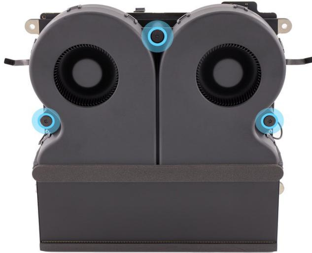
5. Lift the fan off the thermal module.
