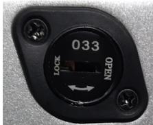
Girare la chiave in senso antiorario fino a posizionarsi sulla posizione di SBLOCCO (simbolo OPEN), estrarre la batteria dalla bicicletta e, dopo averla posizionata su superficie piana e seguendo le precauzioni indicate in merito a procedure di ricarica, inserire la spina del carica batterie nell'apposita presa sulla batteria e successivamente collegare il carica batterie alla presa di rete (230V/50Hz).
