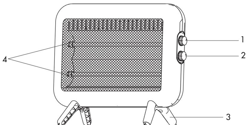
1. Manopola regolazione termostato (utilizzabile solo in modalità COMFORT)
