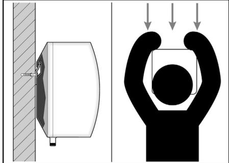
Schema installazione - Installation scheme - Schéma d'installation - Installatieschema - Installationsschema - Esquema de instalaci6n
