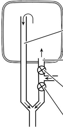
Tubo uscita - Hot water outlet - Tuyau de sortie d'eau - Waterafvoerbuiss
