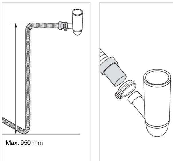
È anche possibile collegare il tubo di scarico a un raccordo sul sifone del lavello. Il raccordo deve avere un diametro interno di almeno 14 mm.
