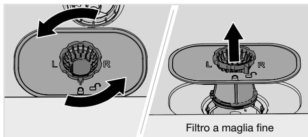
1. Ruotare l'anello di serraggio in senso antiorario e sollevare il filtro a maglia fine verso l'alto.
