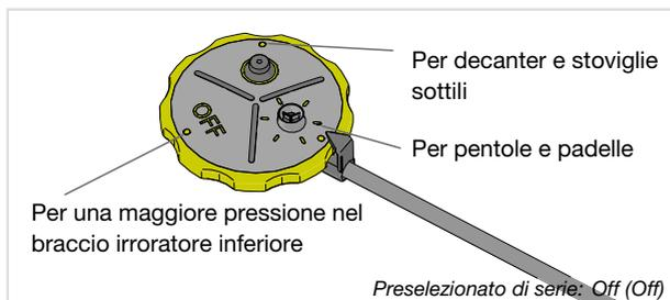
Lasciare aperte le power zone per un maggiore flusso d'acqua nelle posizioni in cui sono state collocate, ad esempio, pentole e padelle o decanter e stoviglie sottili. Chiudere le power zone della lavastoviglie per ottenere una maggiore pressione di irradiazione nel braccio irroratore inferiore.
