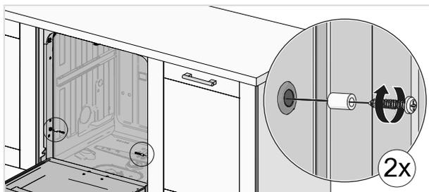
Dopo il fissaggio della macchina, verificare che i piedini anteriori siano ancora a contatto con il pavimento.
