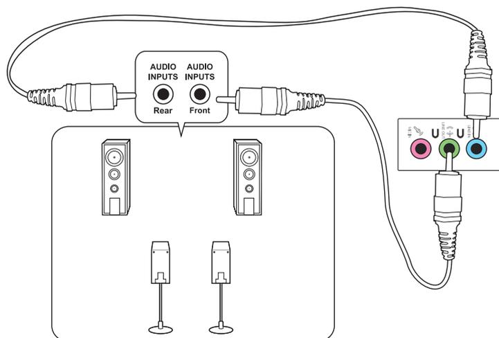
**Collegamento di altoparlanti in configurazione 5.1**
