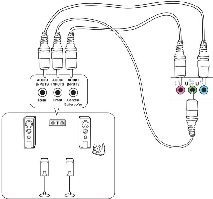
**Collegamento di altoparlanti in configurazione 7.1**
