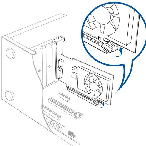
6. Utilizzare un cacciavite e una vite per bloccare la scheda grafica sullo chassis.
