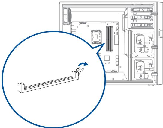
6. Allineare la tacca sul bordo inferiore del modulo DIMM con la chiave del socket DIMM, quindi inserire saldamente il modulo DIMM nel socket finché l'espulsore non scatta in posizione.
