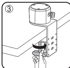
\*Allentare la vite prima di rimuovere il supporto interno del morsetto.
