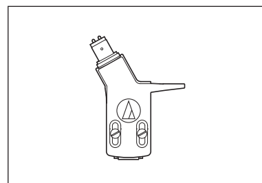
• Porte-cellule (AT-HS3) avec cellule stéréo VM (AT91R)
