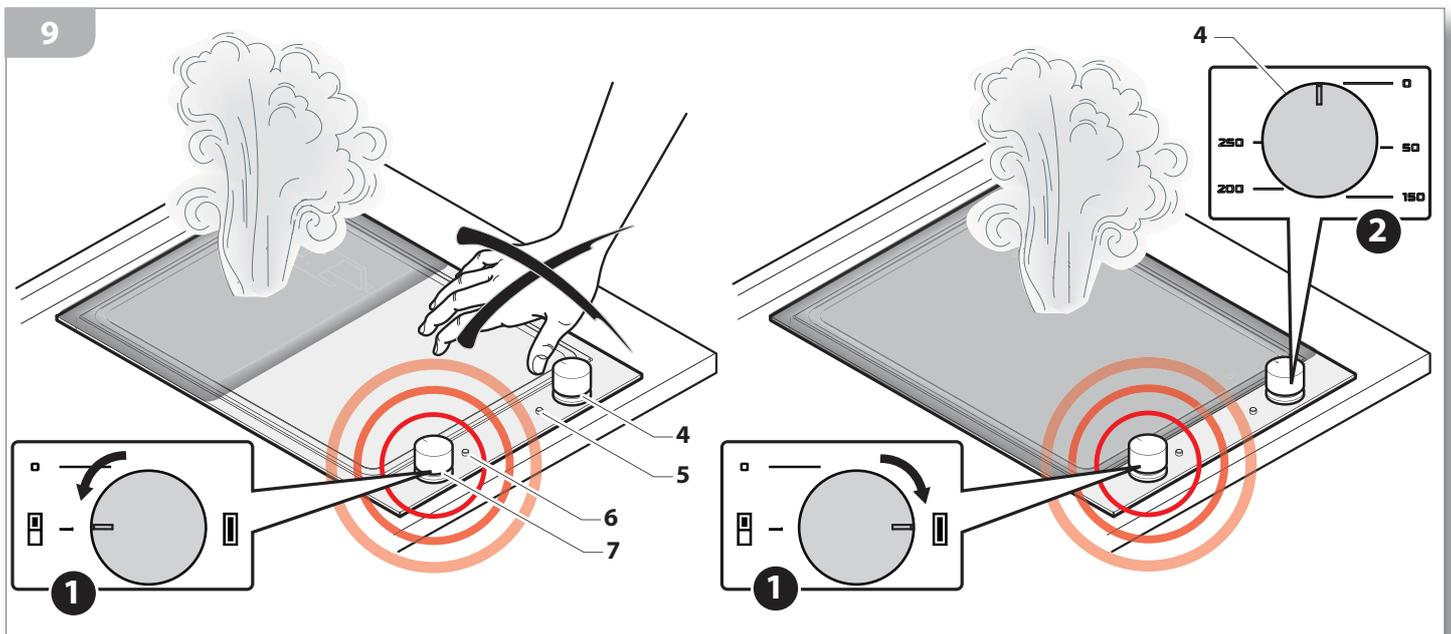
(fig. 9 par. 2) Ruotare la manopola (4) sulla temperatura desiderata, la lampada spia (5) si accenderà per spegnersi una volta raggiunto il valore impostato.
