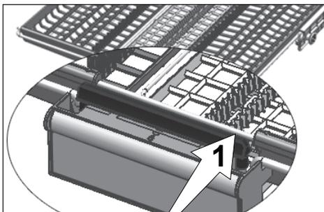
Nei modelli con funzionalità di movimento parziale, spingendo la sbarra (1) sulla maniglia diviene possibile portare alla posizione più bassa il vassoio centrale del cestello e il sistema si sblocca. In tale maniera, i vassoi laterali destro e sinistro possono essere utilizzati come parti mobili. Lo spazio libero che viene a crearsi con i vassoi laterali permette di caricare elementi lunghi sul cestello superiore.
