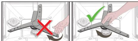
**i** Non tentare di ruotare la girante tenendola per le estremità. Il tentativo di ruotare le sezioni terminali può causare la rottura del sistema di ingranaggi all'interno della girante.
