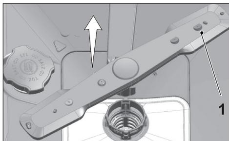
Controllare se i fori della girante inferiore sono intasati. Se sono intasati, rimuovere e pulire il gruppo di girante (a seconda del modello).
