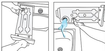
Se si accumula lanugine nell'imbuto del serbatoio dell'acqua, rimuoverle sotto l'acqua corrente.
