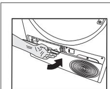
Dopo aver completato il processo di pulizia, rimettere il coperchio del deflettore dell'aria in posizione, spostare i fermi per chiuderlo e chiudere lo zoccolo base.
