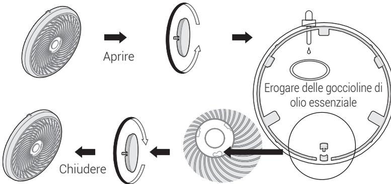
In fase di montaggio, inserire prima il grande foro rotondo secondo il segno di allineamento, quindi ruotare in senso orario
