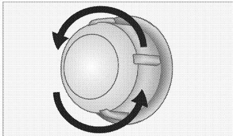
3. Se la lampada del forno è del tipo (A), come mostrato in figura, ruotare la lampada come mostrato in figura e sostituirla con una nuova. Se è del tipo (B), estrarla come mostrato in figura e sostituirla con una nuova.
