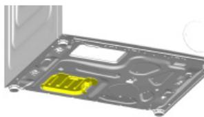
Inclinare leggermente la lavatrice all'indietro. Appoggiare le linguette del coperchio A sul pannello inferiore. Completare il montaggio ruotando il coperchio.
