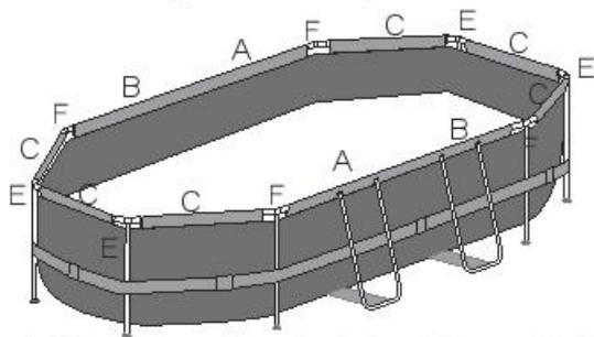
**Hinweis:** Die Installationszeichnung für die obere Schiene und den T-Verbinder von 3.00m x 2.00m x 84cm (9'10" x 6'7" x 33").
