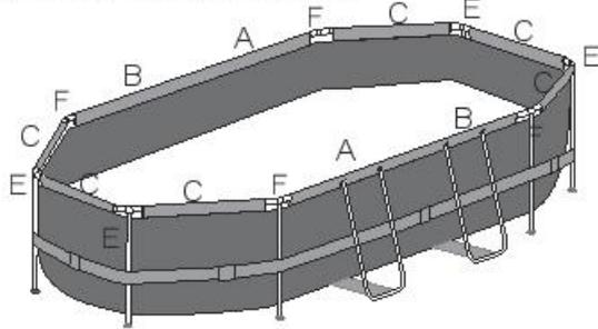
**Opmerking:** De installatietekening voor de bovenste rail en het T-stuk van 3.00m x 2.00m x 84cm (9'10" x 6'7" x 33").
