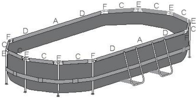
**Opmerking:** De installatietekening voor de bovenste rail en het T-stuk van 4.88m x 3.05m x 1.07m (16' x 10' x 42").
