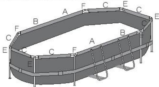
**Remarque:** le dessin d'installation pour le rail supérieur et le raccord en T de 3.00m x 2.00m x 84cm (9pi10po x 6pi7po x 33po).
