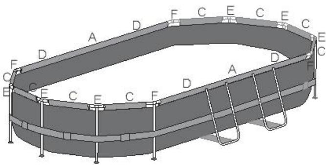
**Hinweis:** Die Installationszeichnung für die obere Schiene und den T-Verbinder von 4.88m x 3.05m x 1.07m (16' x 10' x 42").
