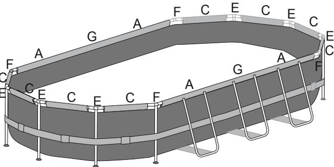
**Nota:** Schema di installazione per guida superiore e connettore a "T" da 5.49m x 2.74m x 1.22m (18' x 9' x 48")
