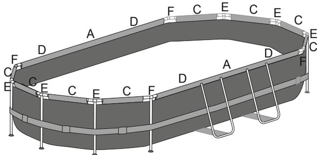
**Nota:** Schema di installazione per guida superiore e connettore a "T" da 4.88m x 3.05m x 1.07m (16' x 10' x 42")
