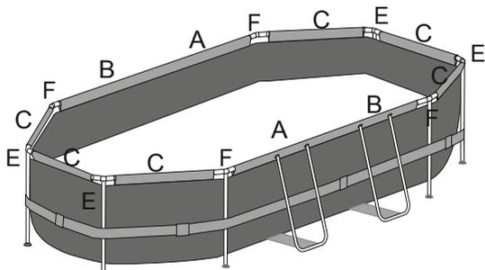
**Nota:** Schema di installazione per guida superiore e connettore a "T" da 3.00m x 2.00m x 84cm (9'10" x 6'7" x 33")
