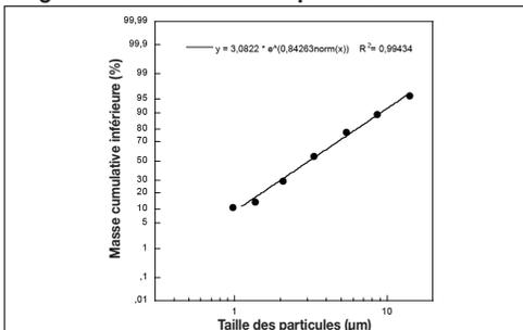
Les mesures ont été effectuées avec une solution de fluorure de sodium à l'aide d'un impacteur NGI (Next Generation Impactor).
