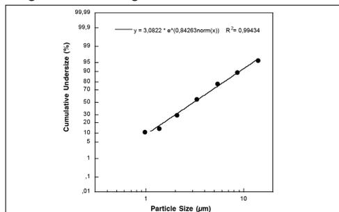
Die Messungen wurden mit einer Natrium-Fluorid-Lösung mit einem "Next Generation Impactor" (NGI) durchgeführt. Das Diagramm ist möglicherweise so nicht auf Suspensionen oder sehr zähflüssige Medikamente anwendbar. Nähere Informationen dazu können Sie vom jeweiligen Medikamentenhersteller erfahren.
