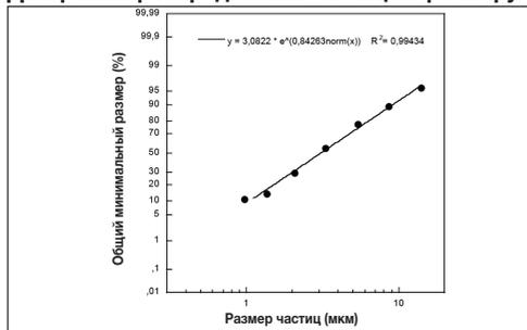
Измерения производились с использованием раствора фторида натрия при помощи импактора нового поколения (Next Generation Impactor = NGI).
