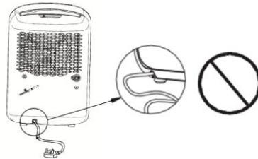
Dieses Gerät muss mit dem mitgelieferten Stecker an eine Steckdose angeschlossen werden. Keine anderen Verbindungen zum Anschluss des Geräts verwenden.
