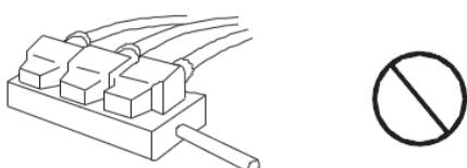
**E**ste aparato debe encenderse y apagarse correctamente, no quite el enchufe de la toma de corriente si el aparato está en funcionamiento. Para periodos prolongados de inactividad, desconecte el enchufe de la toma de corriente.
