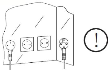
**Q**uesto apparecchio deve essere collegato con la spina in dotazione tramite una presa di corrente, non utilizzare altre connessioni per il collegamento.
