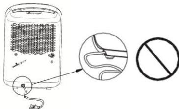
**E**ste aparato debe conectarse con el enchufe suministrado mediante una toma de corriente, no utilice otras conexiones.
