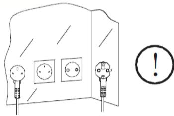
Si le cordon d'alimentation est endommagé, il doit être remplacé par le fabricant ou par son service d'assistance technique ou par une personne tout aussi qualifiée afin d'éviter tout danger.
