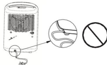
Cet appareil doit être relié à la fiche fournie grâce à une prise de courant, ne pas utiliser d'autres connexions pour la connexion.
