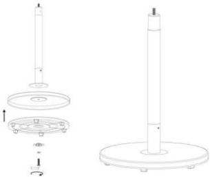
3. Visser dans le sens des aiguilles d'une montre la colonne supérieure (6) sur la colonne intermédiaire.
