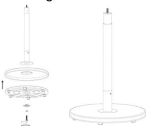
3. Das obere Standrohr (6) im Uhrzeigersinn auf das mittlere Standrohr schrauben.
