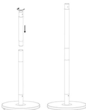
4. Introducir la cabeza del ventilador en la columna superior de tal forma que los dos orificios coincidan, y bloquear los dos elementos atornillando el tornillo (5) en sentido horario y apretando a fondo. Al término de la operación, comprobar que la cabeza del ventilador y la columna están ensambladas correctamente y bien sujetas.
