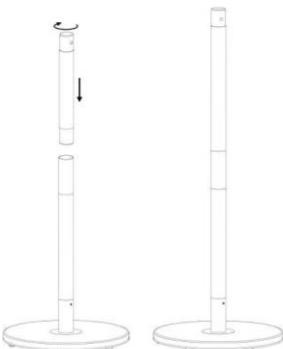
4. Den „Ventilatorkopf“ so auf das obere Standrohr aufstecken, dass die beiden Löcher aufeinandertreffen und durch Eindrehen und Festziehen der Schraube (5) im Uhrzeigersinn sicherstellen, dass der Ventilatorkopf blockiert ist. Nach Abschluss dieses Arbeiten überprüfen, dass der Ventilatorkopf und das Standrohr ordnungsgemäß und fest zusammengebaut sind.
