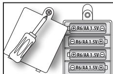
Vervang de batterijen wanneer de geluidskwaliteit te wensen over laat. Voor een lange levensduur wordt het geadviseerd alkalinebatterijen te gebruiken.
