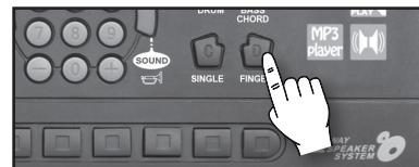
Lorsqu'on compose un accord dans le mode **SINGLE** ou **FINGER**, en enfouissant le bouton **SYNC** (21), on active un rythme et un accompagnement automatique. Si on enfonce le bouton **BASS CHORD** (18), on ajoute un son de basse à l'accord (jusqu'à 5 sons différents).
