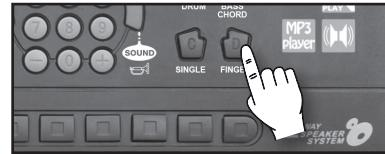
Wenn ein Akkord im Modus **SINGLE** oder **FINGER** komponiert wird, wird durch Druck auf die Taste **SYNC** ⑯ automatisch ein Rhythmus und eine Begleitung aktiviert. Durch Druck auf die Taste **BASS CHORD** ⑰ wird zum Akkord ein Basston hinzugefügt (bis zu 5 verschiedene Töne).
