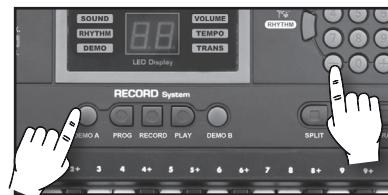
Lorsque le morceau est en cours d'exécution, enfoncer les touches +/- (21) pour sélectionner le morceau suivant ou précédent ou bien taper un chiffre de 0 à 60 pour en choisir un dans la liste présente à la fin de ce manuel;
