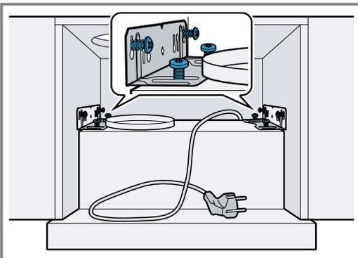
2. Larghezza dell'apparecchio di 90 cm: tirare completamente in avanti il filtro estraibile. Inoltre fissare dal basso l'apparecchio sulle pareti laterali del mobile a pensile utilizzando 2 viti a sinistra e a destra.
