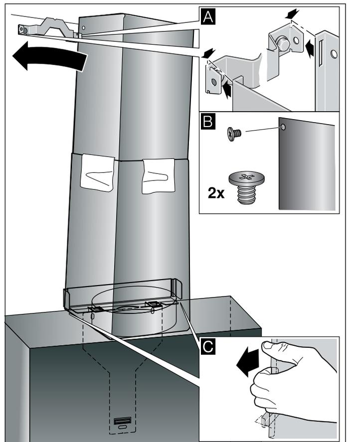
7. Agganciare il rivestimento del camino inferiore alla staffa di fissaggio. Il cavo di collegamento non deve essere danneggiato. **C**
