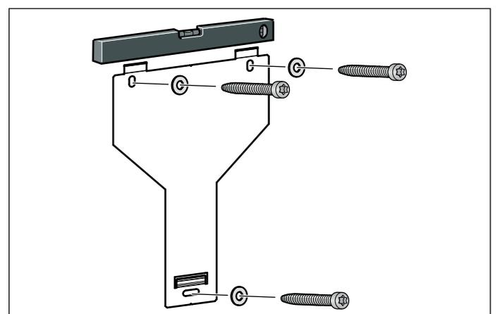
Avvitare a fondo la sospensione per la cappa di aspirazione, allinearla con una bolla e fissarla.
