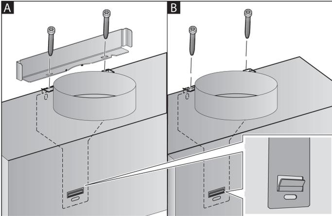
5. Se non viene montato alcun canale, avvitare le due viti di sicurezza senza angolare. **B**
