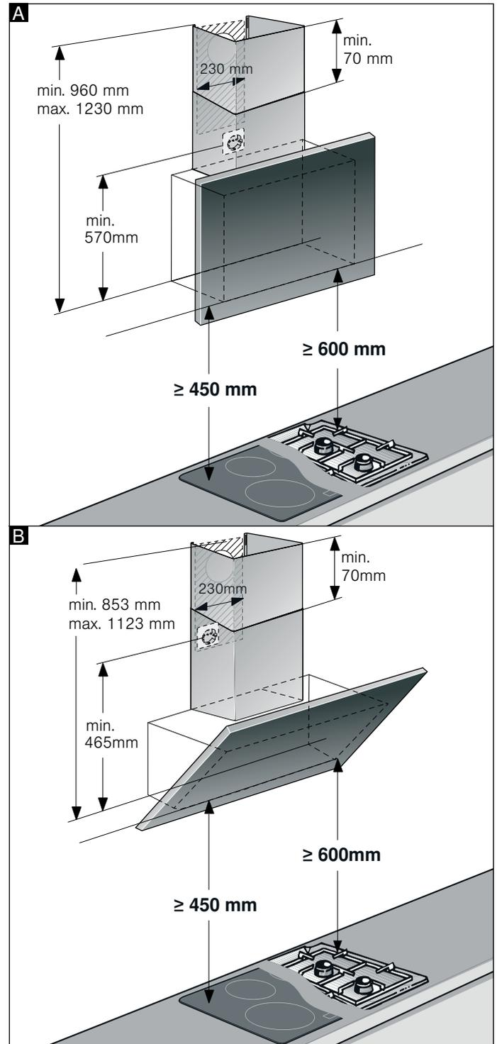
**Avvertenza:** Si consiglia di appendere l'apparecchio in modo tale che il bordo inferiore dello schermo di vetro disegni una linea con il bordo inferiore del mobile a pensile adiacente. Accertarsi che le distanze di sicurezza indicate per il piano di cottura vengano rispettate.
