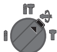
Позиција Vario-Lock за подесување на позицијата на длетото Во оваа позиција, прекинувачот за запирање на удари/вртежи 9 не се вклопува.
