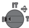
Läge för Borrning utan slag i trä, metall, keramik och plast samt för skruvdragning
