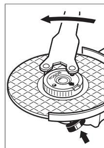
Pour desserrer un écrou de serrage rapide (non endommagé) correctement fixé, tournez avec la main la molette dans le sens antihoraire. **N'essayez jamais de desserrer un écrou de serrage rapide grippé avec une pince, utilisez uniquement la clé à ergots.** Positionnez la clé à ergots comme représenté sur la figure.
