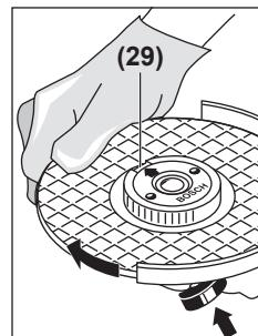
مهره مهار سریع طبق مقررات تعیین شده و بدون عیب را می‌توان با هرخاندن رینگ کنگره دار در خلاف جهت عقربه های ساعت با دست باز کرد. مهره مهار سریع سفت شده را هرگز توسط یک آچار شلاقی باز نکنید، بلکه از یک آچار دو سوزنه استفاده نمایید. آچار قرار دهید. دوسوزن را مانند تصویر
