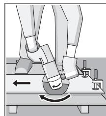
Máy luôn luôn phải được vận hành theo chuyển động mài ở tư thế thẳng đứng. Nếu không như vậy, có nguy cơ bị đẩy **mà không điều khiển** **được máy** ra khỏi mạch cắt. Khi cắt một thanh vật liệu có mặt nghiêng và góc vuông, tốt nhất là bắt đầu tại điểm có thiết diện nhỏ nhất.
