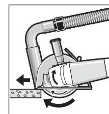
接通电动工具，并把引导滑座的前部放在工件上。参考工件的物料，适当地施力推进机器。切割高硬度的工件时，例如碎石含量很高的水泥，可能因为金刚石切割片过热而导致切割片损坏。金刚石切割片的周围会出现明显的火花。
