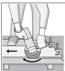
Arah pemotongan harus selalu berlawanan dengan arah gerak dari alat kerja. Jika tidak, terdapat risiko perkakas listrik tertekan **tak terkendali** pada jalur pemotongan. Selama memotong profil atau tabung persegi, gunakan penampang terkecil untuk hasil pemotongan terbaik.
