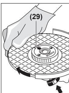
Khóa trực máy mài bằng nút khóa trực máy (1). Để siết chặt dai ốc khóa nhanh, xoay thật chât dĩa mài theo chiều đồng hồ.
