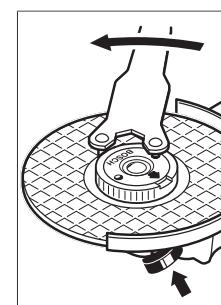
如果安装正确而且快速夹紧螺母未损坏，就可以用手逆时针方向松开滚花圆环。对于卡住的快速夹紧螺母，不要用钳子而是要用双销扳手松开。请参考插图安装双销扳手。
