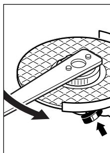
如果安装正确而且快速夹紧螺母未损坏，就可以用手逆时针方向松开滚花圆环。对于卡住的快速夹紧螺母，不要用钳子而是要用组合扳手松开。如图所示安装组合扳手。
