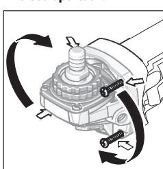
La tête de meuleuse peut être tournée par pas de 90°. Cela permet, lors de certaines applications, d'amener l'interrupteur Marche/Arrêt dans une meilleure position de prise en main, par ex. pour les gauchers. Retirez les 4 vis. Faites pivoter avec précaution la tête de meuleuse dans la nouvelle position **sans la désolidariser du carter**. Resserrez les 4 vis.
