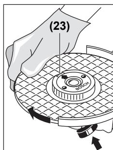
مهار سریع طبق مقررات تعیین شده و بدون عیب را می‌توان با پرخاندن رینگ کنگره دار در خلاف جهت عقربه‌های ساعت با دست باز کرد. مهار سریع سفت شده را هرگز توسط یک آچار شلاقی باز نکنید، بلکه از یک آچار بکس استفاده نمایید. آچار بکس را مانند تصویر قرار دهد.
