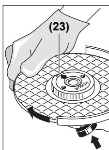
按壓主軸鎖止按鈕 (1)，以便鎖定磨削主軸。順時針用力轉動研磨砂輪即可將快速螺母旋緊。
