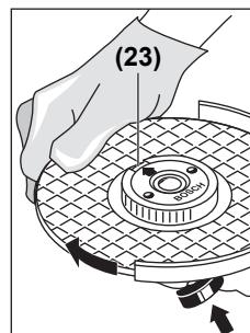
Khóa trực máy mài bằng nút khóa trực máy (1). Để siết chặt dai ốc khóa nhanh, xoay thật chặt dĩa mài theo chiều đồng hồ.
