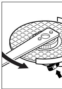
快速螺母如果安裝正確且無任何受損，您可徒手從滾花位置逆時針旋轉，如此即可鬆開快速螺母。如果無法用手取出快速螺母，則要使用複合扳手轉鬆螺母，千萬不可以使用鉗子強行轉開螺母。請按圖示架上複合扳手。
