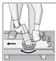
ต้องเคลื่อนเครื่องมือไฟฟ้า แบบบังเข็นเลmo มีจะนันจะ เกิดอันตรายจากการที่ เครื่องถูกผลักออกจากการ ตัดอย่างควบคุมไม่ได้ เมื่อ ต้องการตัดเล่นรอบนอกและ ท่อสีเหลี่ยม ขอแนะนำให้ เริ่มตรงดูที่มีหน้าตัดที่เล็ก ที่สุด
