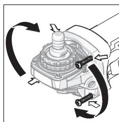
可将机头旋转90度。这样就能在特殊工作状况下将电源开关置于比较容易操作的位置，例如针对左撇子。
