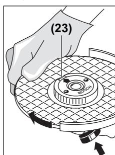
Tekan tombol penahan spindel (1) untuk menahan spindel gerinda. Untuk mengencangkan mur quick-clamping, putar mata gerinda searah jarum jam dengan kuat.
