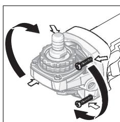
ท่านสามารถหมุนหัวเครื่อง ได้เป็นทิศทาง 90° ใน ลักษณะที่ท่านสามารถนำ ทิศเปิดปิดไปยังตำแหน่งที่ สะดวกต่อการใช้งานยิ่งขึ้น สำหรับสภาพการทำงาน พิเศษ ด. ย. เช่น สำหรับผู้ นัดเมือข่าย
