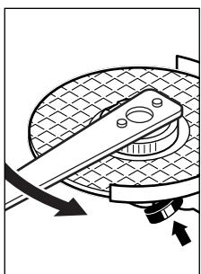
Pour desserrer un écrou de serrage rapide (non endommagé) correctement fixé, tournez avec la main la molette dans le sens antihoraire. **Ne desserrez jamais un écrou de serrage rapide bloqué au moyen d'une pince mais utilisez la clé combinée.** Placez la clé combinée comme représenté sur la figure.
