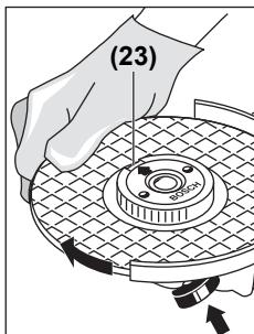
Actionnez le bouton de blocage de broche (1) pour bloquer la broche. Pour serrer l'écrou de serrage rapide, faites tourner d'un geste ferme la meule/le disque dans le sens horaire.
