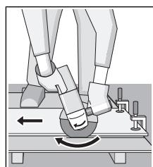
Máy luôn luôn phải được vận hành theo chuyển động mài ở tư thế thẳng đứng. Nếu không như vậy, có nguy cơ bị dây mài không điều khiển được máy ra khỏi mạch cắt. Khi cắt một thanh vật liệu có mặt nghiêng và góc vuông, tốt nhất là bắt đầu tại điểm có thiết diện nhỏ nhất.
