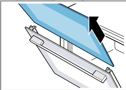
7. In caso di necessità è possibile estrarre la barra per la condensa per la pulizia.
