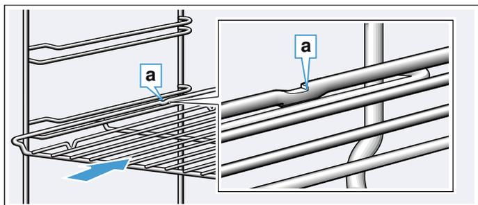
Durante l'inserimento dei pannelli, prestare attenzione a che la scanalatura di arresto **a** si trovi nella parte posteriore e sia rivolta verso il basso. La smussatura dell'accessorio **b** deve essere rivolta in avanti verso lo sportello dell'apparecchio.
