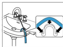
Fissare e assicurare il raccordo di scarico dell'acqua con un collettore → *Pagina 31.*
