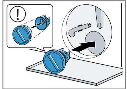
5. Chiudere il coperchio della pompa ruotandolo finché non si innesta.
