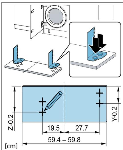
4. **Nota:** Nell'inserimento del pannello dello zoccolo, prestare attenzione a che il timelight non sia visibile se lo zoccolo è tirato in avanti oppure con il pannello del mobile a filo. Montare il pannello dello zoccolo.
