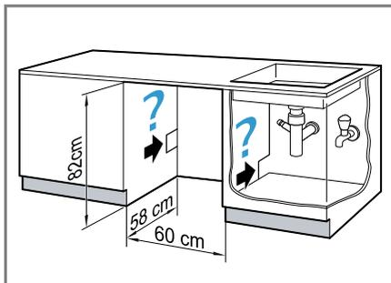
3. Posare il cavo di collegamento, nonché i tubi flessibili di carico e scarico dell'acqua.
