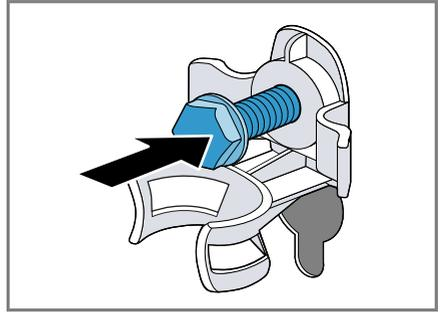
4. Inserire il cavo di collegamento nell'alloggiamento ① e serrare tutte e 4 le viti dei blocchi di trasporto con una chiave inglese da 13 ②.
