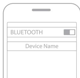
Una volta effettuata la connessione, si attiva un segnale acustico. La barra luminosa si illumina di bianco fisso, quindi sfuma in nero e il nome del diffusore viene visualizzato nell'elenco dei dispositivi mobili.
