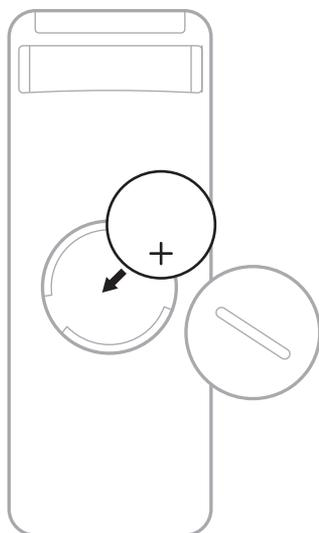
**NOTA:** usare solo batterie al litio CR2032 o DL2032 da 3 V approvate da un ente per la sicurezza (ad es. UL).
