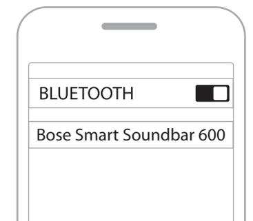
Una volta stabilita la connessione, si sente un segnale acustico, la barra luminosa si accende con luce bianca fissa e poi sfuma in nero. Il nome della soundbar viene visualizzato nell'elenco dei dispositivi mobili.
