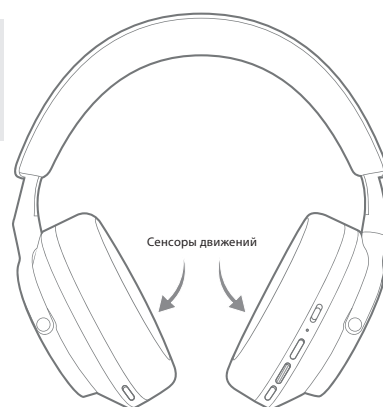
Diagram 3 Расположение сенсоров приближения
