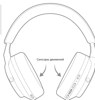
Diagram 3 Расположение сенсоров приближения
