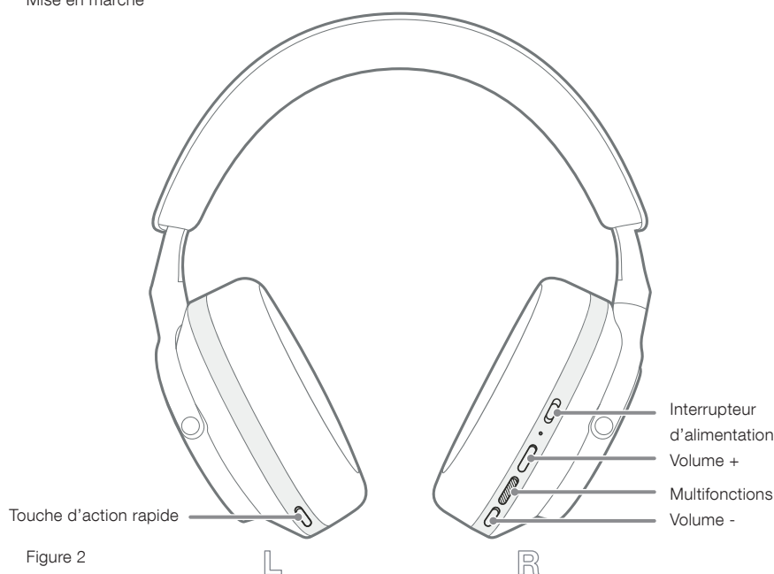
Figure 1 Mise en marche
