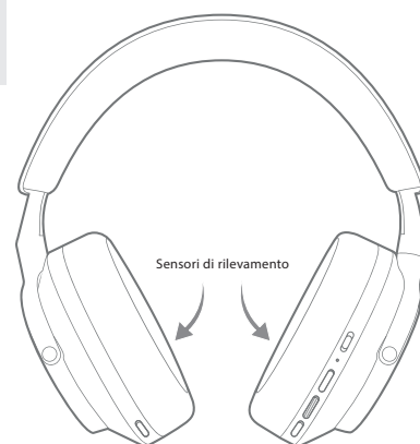
Diagramma 3 Ubicazione del sensore di rilevamento
