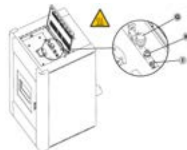
Fig. 47 - Valvola di sfianto manuale posta sotto il top (Idro Prince 3 30-30 H2O)
