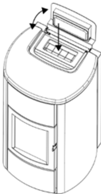
Fig. 38 - Carica del pellet
