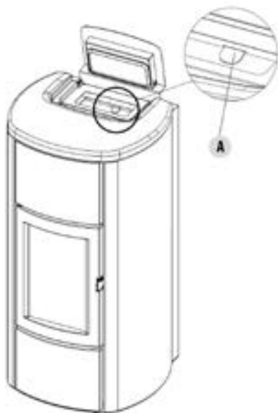
Fig. 64 - Leva per pulizia turbolatori (Idro Prince 3 16-23-23 H 2 O, Aquos 3 16-23-23 H 2 O, Idron 16-22 Airtight, Hidrofire 22.8)
