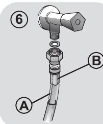
**WASSERSTOP (Abbildung 5):** Im Falle eines defekten Schlauches stoppt die Wasserzufuhr. In diesem Fall erscheint auf dem Fenster „A“ ein rotes Feld und der Schlauch muss entfernt werden. Um die Schraubenmutter zu lösen, drücken Sie den Entsicherungsknopf „B“.
