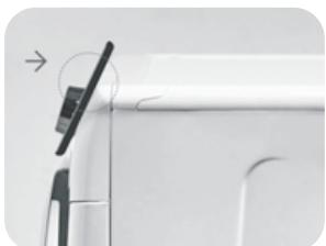
Se non si conosce la posizione dell'antenna NFC, spostare leggermente lo smartphone con movimento circolare sul logo Smart Touch fino a quando l'App segnala l'avvenuta connessione.
