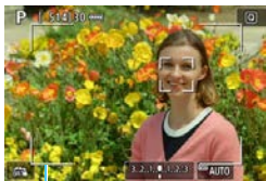
Cornice dell'area AF
