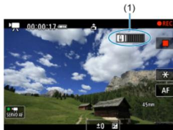
Con l'aumento della temperatura interna, il livello sull'indicatore aumenta verso destra. La velocità di aumento del livello dipende dalle condizioni di scatto. I livelli da 1 a 7 sono contrassegnati in bianco, ma quando la temperatura raggiunge il livello 8, il colore cambia.
