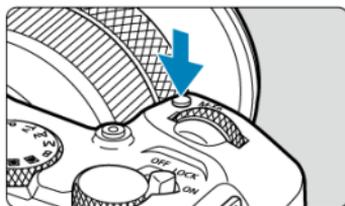
Premendo il pulsante <M-Fn> una volta (o ripetutamente) e quindi ruotando la ghiera < > o < >, è possibile impostare il bilanciamento del bianco (), la modalità drive (), la compensazione esposizione flash (), lo stile Foto (), la modalità di misurazione (), il funzionamento di AF (), la sensibilità ISO () e l'area AF ().
