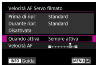
È possibile impostare **[Sempre attiva]** per applicare la velocità dell'AF in ogni momento per la ripresa di filmati (prima e durante la registrazione di filmati) o impostare **[Durante ripresa]** per applicare la velocità dell'AF solo durante la registrazione di filmati.
