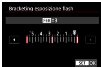
Gli Speedlite dotati di bracketing esposizione flash (FEB) possono modificare automaticamente la potenza del flash esterno scattando tre foto alla volta.
