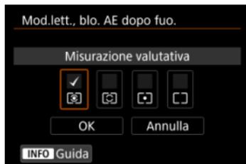
Per ogni modalità di misurazione, è possibile specificare se bloccare l'esposizione (blocco AE) una volta che i soggetti sono a fuoco con AF One-Shot. L'esposizione viene bloccata mentre si tiene premuto a metà il pulsante di scatto. Selezionare i modi misurazione per il blocco AE e aggiungere un segno di spunta [✓]. Selezionare [OK] per registrare l'impostazione.
