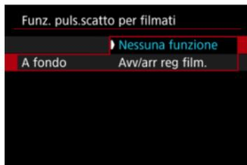
Con **[A fondo]** impostato su **[Avv/arr reg film.]**, è possibile avviare/interrompere la registrazione di filmati non solo tramite il pulsante di ripresa del filmato, ma anche premendo completamente il pulsante di scatto, oppure utilizzando il comando a distanza RS-60E3 (venduto separatamente).
